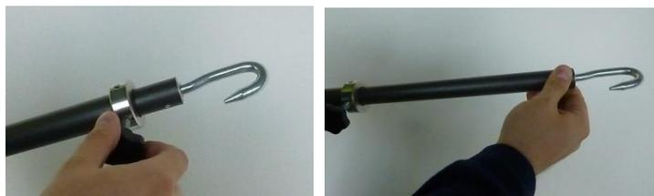
7. Desserrer le bouton de blocage du télescope de soutien et sortir la partie supérieure du télescope de  $0,7 \div 1$ m.
