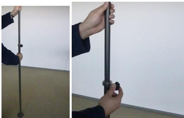
3. Insérer la partie inférieure du télescope dans le pied en l'enfonçant et en la tournant de 90°, puis en bloquant le support librement par le ressort du pied. Serrer ensuite le bouton du télescope jusqu'à ce qu'une résistance perceptible soit ressentie.
