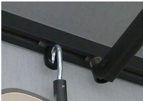
2. Czynność powtórzyć dla drugiej podpory. Insérez le crochet du support télescopique dans le boulon à œil fixé sur la barre avant du store banne. Répétez l'opération pour le deuxième support.
