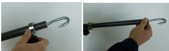
1. Desserrer le bouton de blocage du télescope de soutien et sortir la partie supérieure du télescope de 0,7 ÷ 1m.
