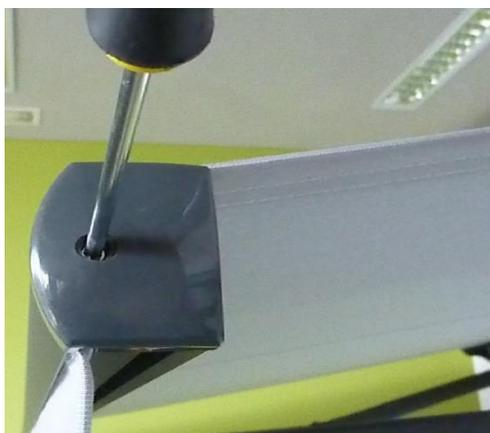
3. Aux deux extrémités de la barre frontale, dévisser les vis de fixation et retirer les côtés en les poussant vers l'extérieur.
